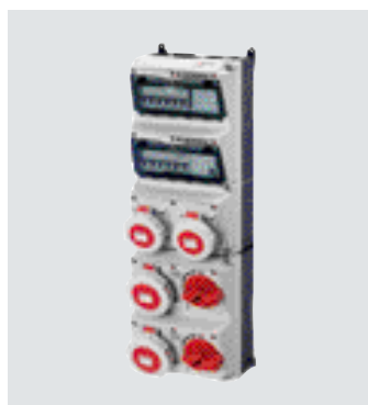
Pistorasiat 2 CEE 32 A, 5-nap., 400 V kytkimellinen, mekaanisella DUO-lukituksella 2 CEE 16 A, 5-nap., 400 V
